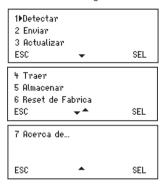
• Detectar : Ejecuta el proceso de detección del módulo conectado.
